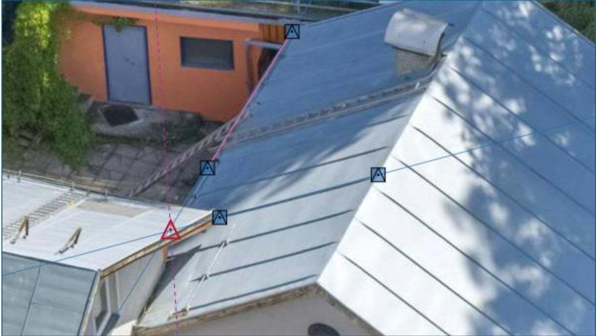
Abb. 19: Hilfslinien (blau strichliert) helfen bei der Konstruktion von Objekten in schwer einsehbaren Bildbereichen
